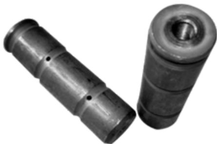
Ось суппорта под смазку и стопор МАЗ-6430,5440 (D=30, L=101)
